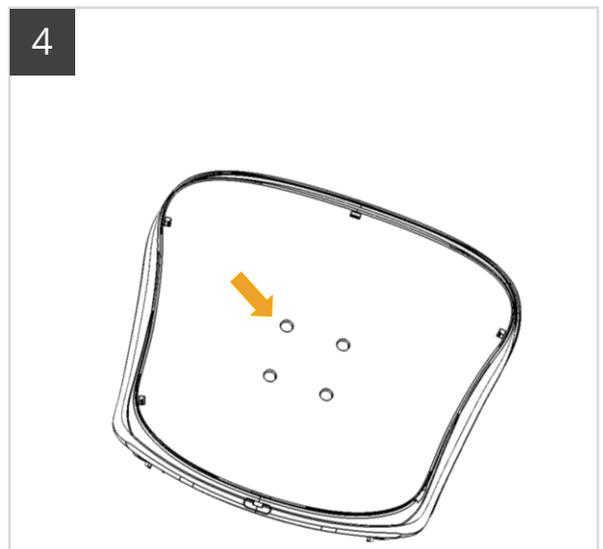
Revissez les 4 vis du patin puis retournez le luminaire pour le mettre en position sur le toit.
