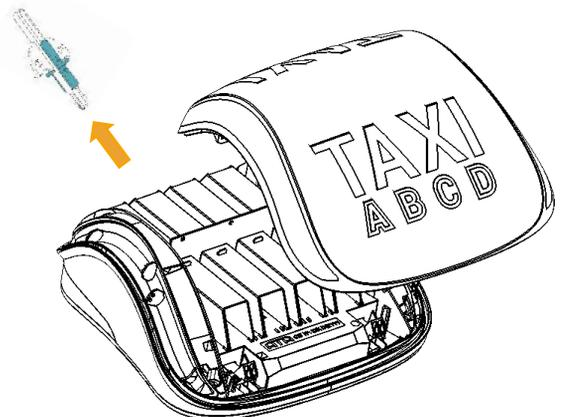
Tirez sur la clé vers l'arrière jusqu'à l'ouverture du caisson.
