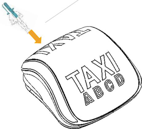
Insérez la clé en position ouverte dans l'encoche située à l'arrière du luminaire. Mettez la clé en position fermée.
