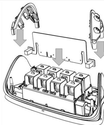
⚠ Attention, vérifiez que les fils électriques sont correctement positionnés sans risque de pincement
